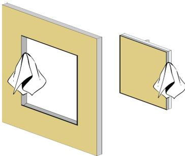
Cubrir atentamente los cierres de click antes de pintar y limpiar eventuales residuos de pintura sobre los dos marcos (interior y exterior). Tener cuidado de no dañar la junta: esta debe quedar intacta después de la instalación.
