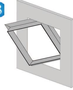
Insertar el marco exterior de la trampilla en la apertura, haciéndolo girar en diagonal hacia el interior del corte realizado. En caso de instalación sobre pared los click de cierre deben quedar la parte superior.
